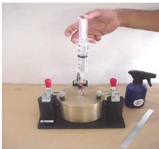
Figura 242 - 4. Uso de la jeringa para completar el llenado del picnómetro pequeño con agua
