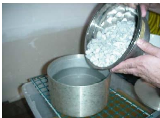
Figura 242 - 21. Adición de la muestra al picnómetro
