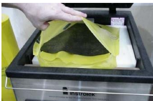
Figura 242 - 27. Colocación de la segunda lámina de caucho sobre la bolsa pequeña
