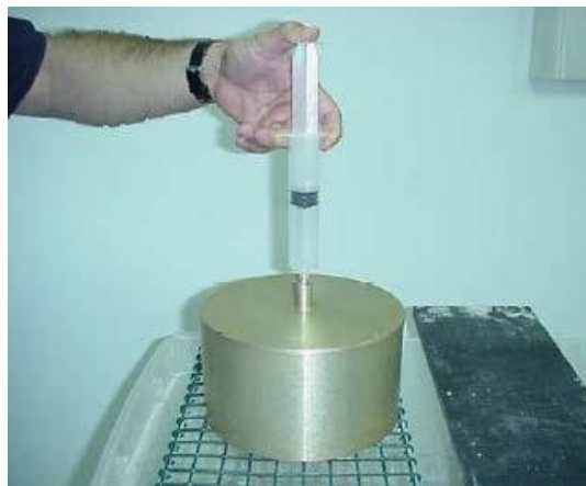
Figura 242 - 8. Uso de la jeringa para completar el llenado del picnómetro grande con agua
