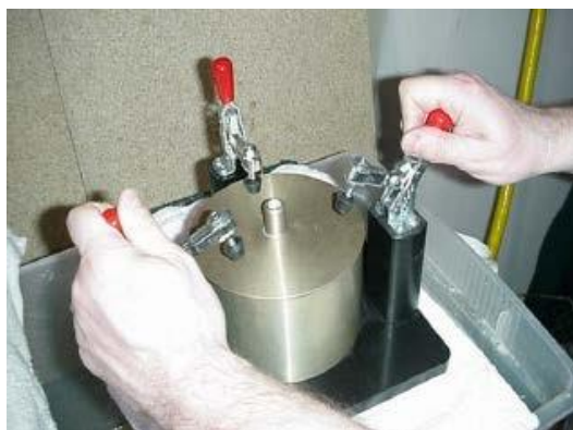
Figura 242 - 15. Se coloca la tapa y se aseguran las abrazaderas
