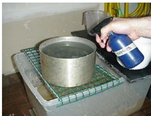
Figura 242 - 23. Rocío de alcohol para remover burbujas de aire
