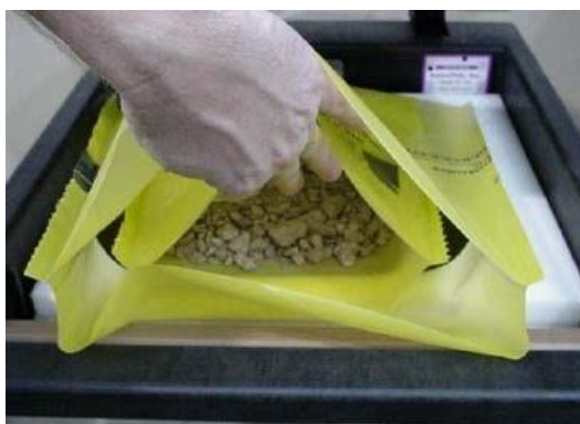
Figura 242 - 26. Colocación de la bolsa pequeña con la muestra dentro de la bolsa grande
