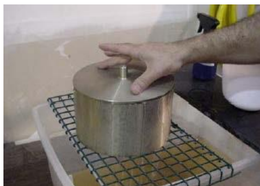
Figura 242 - 24. Colocación de la tapa del picnómetro
