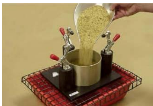
Figura 242 - 12. Adición de la muestra al picnómetro
