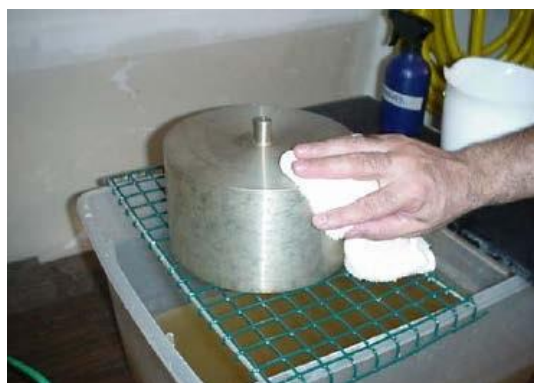
Figura 242 - 9. Secado exterior del picnómetro grande
