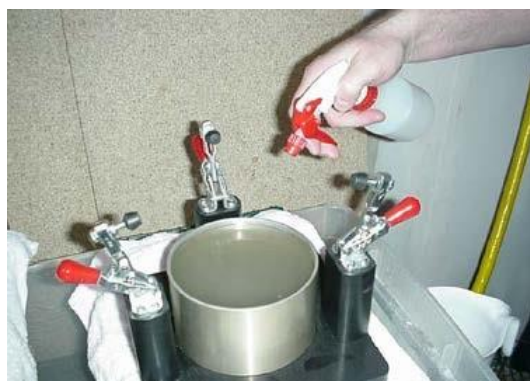
Figura 242 - 14. Aplicación de alcohol para remover las burbujas de aire
