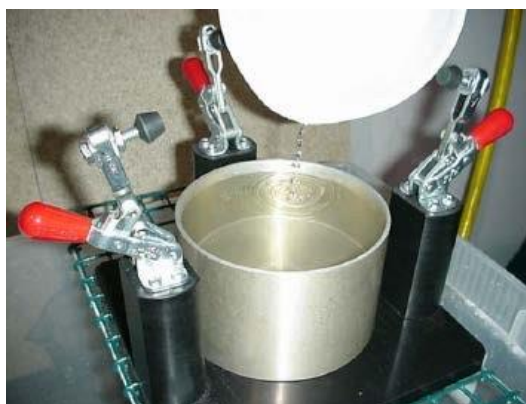
Figura 242 - 3. Llenado del picnómetro pequeño con agua
