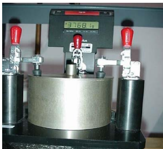
Figura 242 - 5. Pesaje del picnómetro lleno de agua
