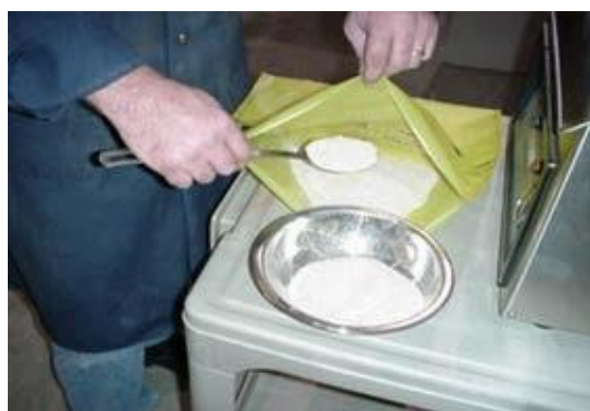
Figura 242 - 17. Colocación de la muestra dentro de la bolsa plástica
