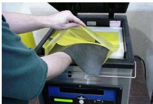
Figura 242 - 25. Colocación de la primera lámina de caucho dentro de la bolsa grande
