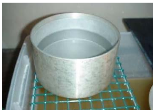
Figura 242 - 20. Picnómetro grande lleno de agua hasta la mitad
