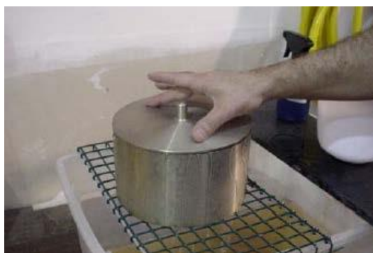
Figura 242 - 7. Colocación de la tapa sobre el picnómetro
