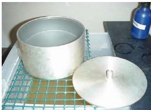
Figura 242 - 6. Picnómetro grande lleno de agua
